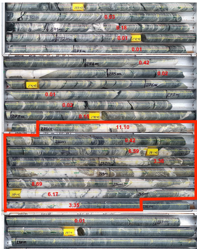
Figure 1 : Trou de forage au diamant DDH0154 – Brèche à veine de quartz-carbonate à haute teneur dans la zone de cisaillement
